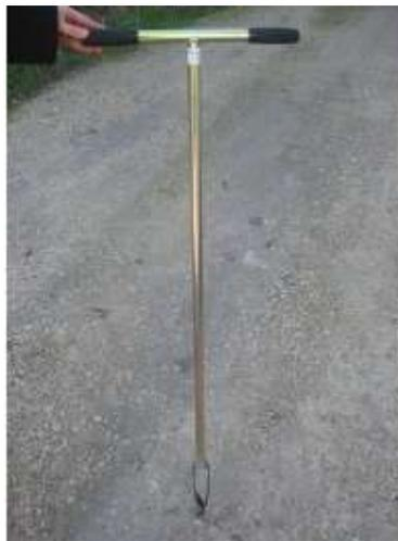
Figure 7 : Tarière manuelle utilisée pour les sondages
